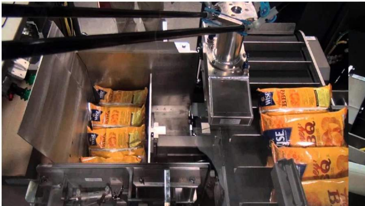
Slika 5. Primjer robota za pakiranje vrećica
