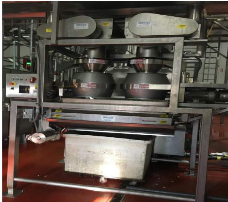
Slika 2. Primjer sekcije za rezanje krumpira na listiće, sa dvije rezne glave.
