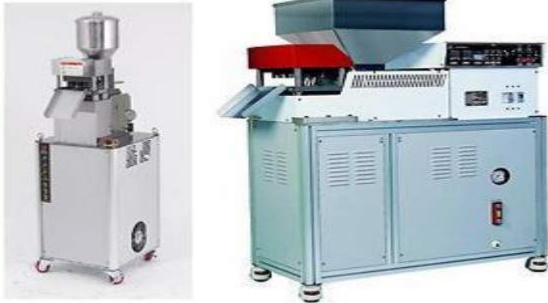
Slika 3. Primjer stroja za izradu ekspandiranog čipsa od peleta
